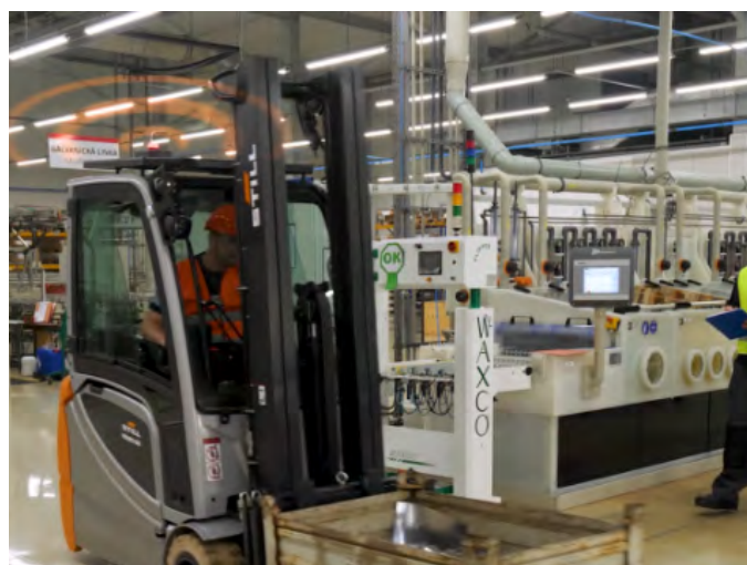
výstražná zóna - VZV autonómne spomaľuje, osobné tagy vibrujú
