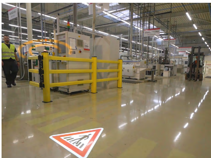
výstražná zóna - pripojenie k LED podlahovému značeniu (zmena symbolu)
